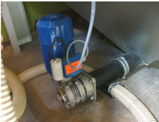
Skruvmotor monterad på vakuumutloppet. Effekt 0,37 kW/29rpm per minut.
