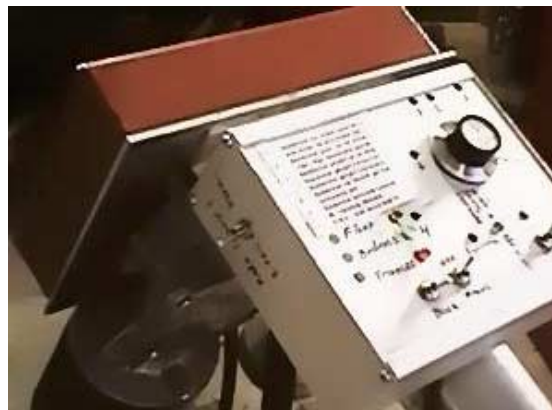
Fig4 Bilden visar styrboxen med alla funktioner och möjliga justeringar. Det är lätt att man "skruvar bort sig" när man inte ser värdena.
