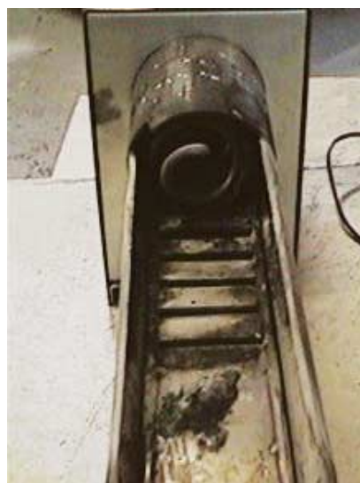
Fig 3. Bilden visar brännaren framifrån med ett lätt utbytbart roster
